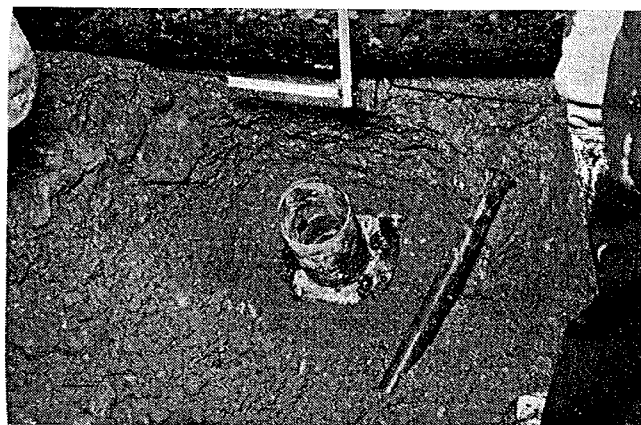
Fig. 5 - Prelievo di campioni indisturbati nel corpo del diaframma per le misure del coefficiente di permeabilità.
