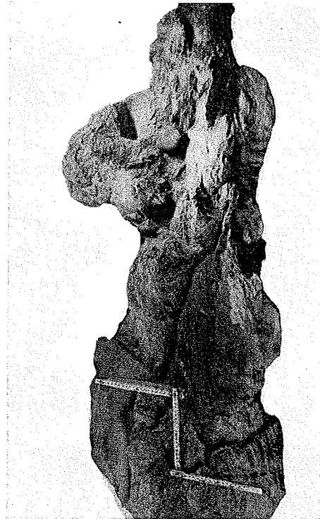
Fig. 4. - Aspetto del bulbo di un micropalo eseguito a Wallisellen e successivamente estratto dal terreno. (Docum. Swissboring)
