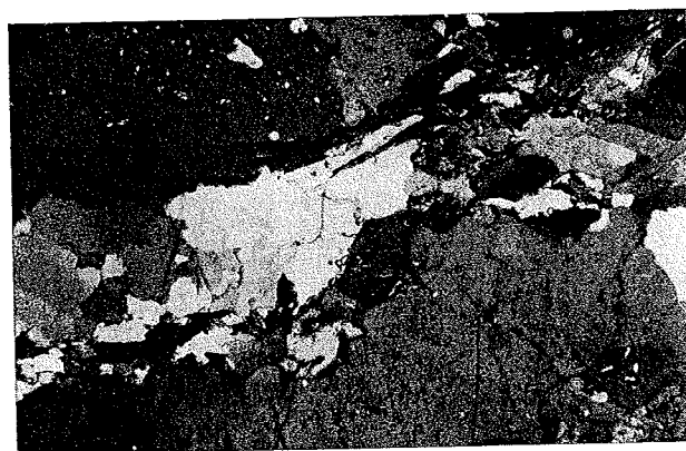
Fig. 3. - Sezione sottile del serizzo ( \times 20 ). Una fascia di individui cristallini a grana fine costituita da quarzo, feldspato e biotite è compresa tra due porfiroblasti di ortoclasio. A scala microscopica la tessitura orientata della roccia risulta meno evidente. Non tutte le lamine di biotite sono rigorosamente orientate.
