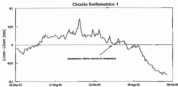
Fig. 15 - Cedimenti rilevati nel circuito livellometrico n.1, depurati dell'effetto temperatura.
