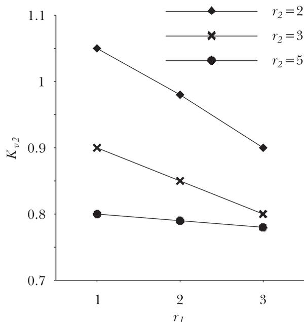
Fig. 9 - Parameter  $K_{v2}$  as a function of  $r_1$  e  $r_2$ .Fig. 9 - Andamento del parametro  $K_{v2}$  in funzione di  $r_1$  e  $r_2$ .
