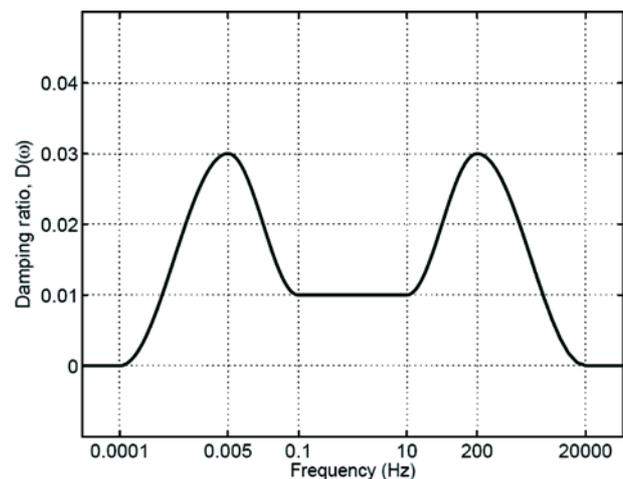
Fig. 8 – Extension outside the domain of definition of the small-strain, damping ratio spectrum proposed in qualitative terms by SHIBUYA *et al.* [1995] for fine-grained soils. *Fig. 8 – Estensione all'esterno del dominio di definizione dello spettro del rapporto di smorzamento a piccole deformazioni proposto in termini qualitativi da SHIBUYA *et al.* [1995] per terreni a grana fine.*
